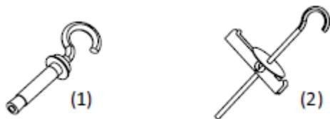
Para techo macizo, deberá utilizar una broca de 9mm y el tornillo de expansión (1), introduciendo el mismo hasta la arandela inferior y girando en sentido horario el gancho (ayúdese de alguna herramienta para esta operación). A continuación gire la tuerca inferior un par de vueltas hasta que ofrezca resistencia.
